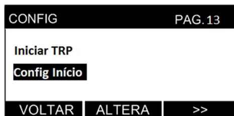
3. Deve-se utilizar a tecla **>>** para navegar entre os dígitos e as teclas **DEC** e **INC** para alterar as informações de dia, mês, ano, hora e minuto, para realizar o ajuste de data e hora. O campo MINUTO tem passo de 10 unidades, sendo possível programar os valores "00", "10", "20", "30", "40" ou "50".
