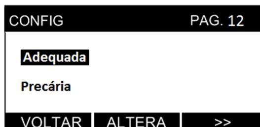
3. “Limite Sup” e “Limite Inf.”: Deve-se utilizar a tecla **>>** para navegar entre os dígitos e as teclas **DEC** e **INC** para alterar as informações de limites de tensão adequada ou precária de acordo com os valores descritos no módulo 8 do Prodist – Revisão 6. Ao confir
