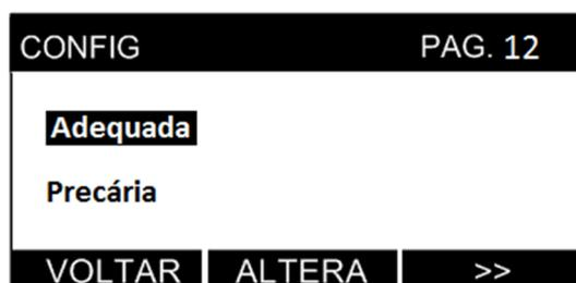
3. “Limite Sup” e “Limite Inf.”: Deve-se utilizar a tecla **>>** para navegar entre os dígitos e as teclas **DEC** e **INC** para alterar as informações de limites de tensão adequada ou precária de acordo com os valores descritos no módulo 8 do Prodist – Revisão vigente. Ao concluir, confirme a mudança com **>>**.
